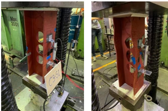
รูปที่ 1 ตัวอย่างการติดตั้งชิ้นงานทดสอบ(ซ้าย) ชิ้นงานหลังจากการทดสอบ(ขวา)
